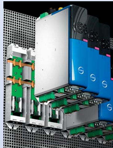
Zwischenkreiskopplung durch Montage der Antriebsregler SD6 auf elektrisch verbundenen Quick DC Link Elementen (Bildhintergrund)
