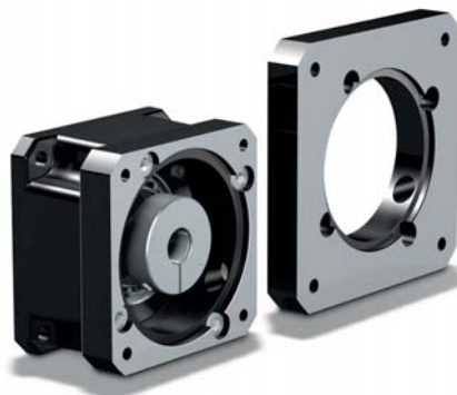
Esempio di un adattatore motore ME 30 in due parti: La realizzazione con piastra di adattamento separata per il lato motore offre la possibilità di installare il dispositivo, senza grandi difficoltà, su servomotori di pressoché tutte le dimensioni
