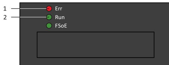
Abb. 3: Leuchtdioden für den EtherCAT-Zustand
