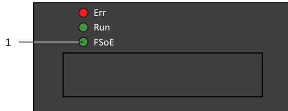
Abb. 4: Leuchtdiode für den FSoE-Zustand
