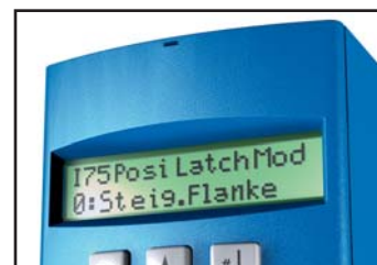
Die POSILatch-Funktion nutzt externe Signale und wertet diese als Messfunktion aus. POSILatch kann ein gesondertes Mess-System der SPS ersetzen
