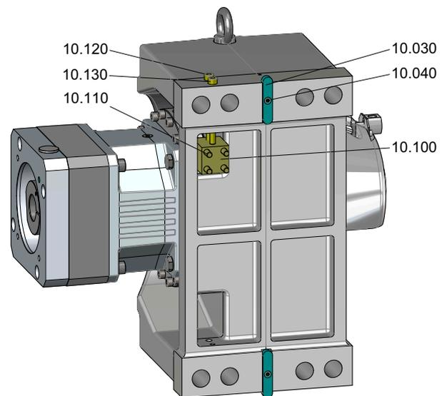
Fig. 2-2 Montage de la cale de réglage (option)
