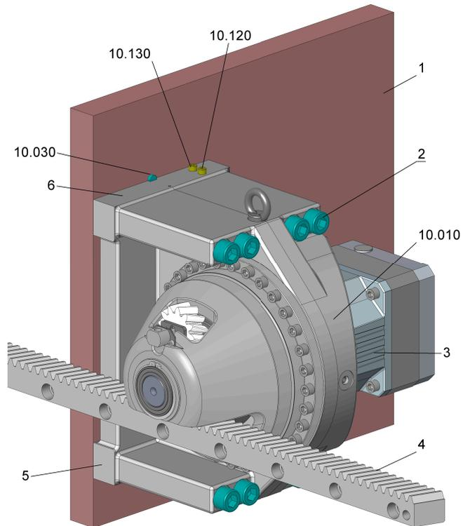
Fig. 2-1 Montage de l'équerre de fixation
