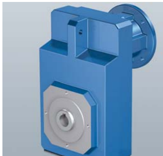
MGS Flachgetriebe F 5 Baugrößen: F1 – F6 Beschleunigungsmoment: 120 – 1.100 Nm Übersetzungen: 4 – 550 Drehspiel: Standard < 10 – 11 arcmin reduziert < 5 – 8 arcmin Extrem flaches Getriebegehäuse mit großer Achsdistanz
