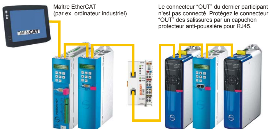
Fig. 4-1 Structure d'un réseau EtherCAT
