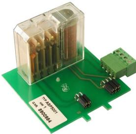
Module optionnel pour réaliser la fonction de sécurité Safe Torque Off (STO) intégrée. Le montage de l'ASP 5001 peut uniquement être exécuté par STÖBER Antriebstechnik GmbH + Co. KG !
