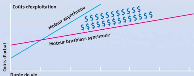
Avec le codeur EnDat® ou Hyperface, les moteurs brushless synchrones EZ à rendement élevé fournissent pour chaque situation d'entraînement uniquement la puissance réellement requise et évitent ainsi tout gaspillage.
