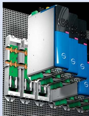
Couplage du circuit intermédiaire en montant le servo-variateur SD6 sur des éléments Quick DC Link reliés électriquement (arrière plan de l'image)
