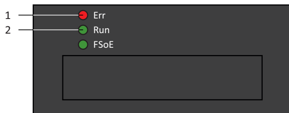
Abb. 5: Leuchtdioden für den EtherCAT-Zustand
