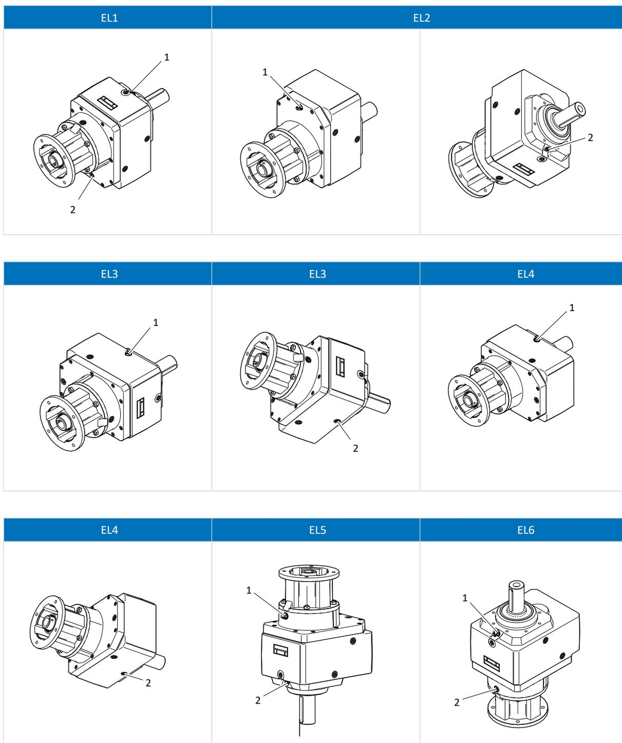
1 Válvula de purga (conexión de llenado)
