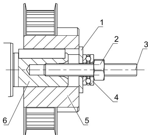
Fig. 3: Dispositivo de extracción para una polea (ejemplo)
