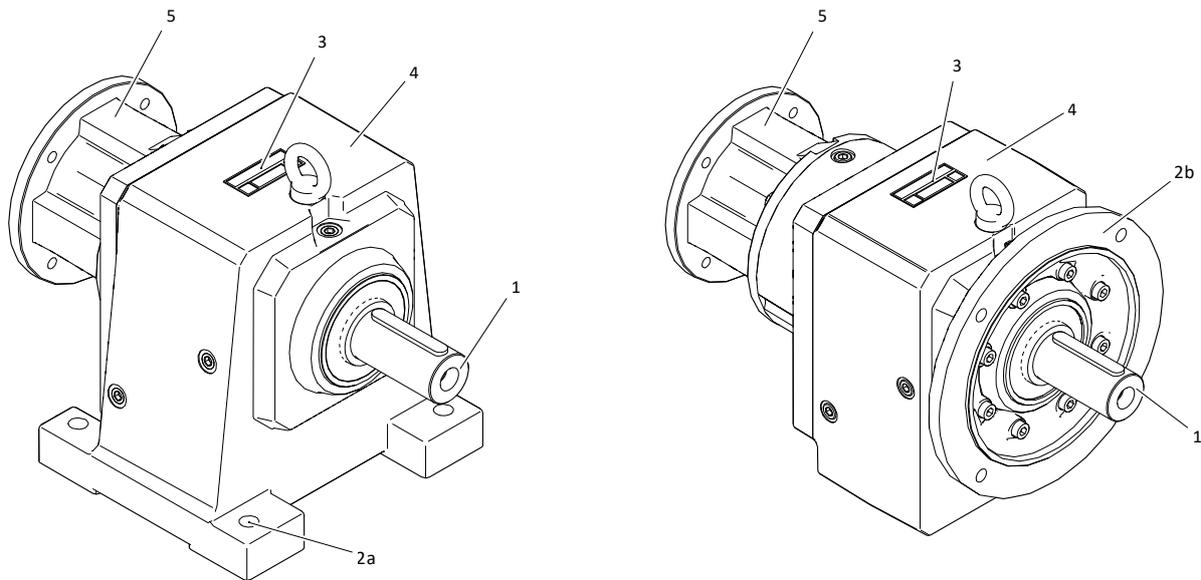
Tab. 1: Estructura principal de un reductor C613N (izquierda) y un reductor C613F (derecha)
