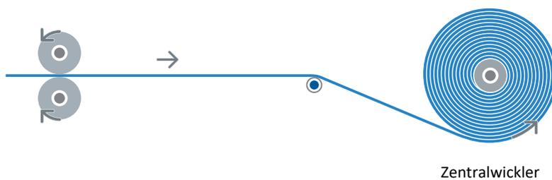
Abb. 27: Zentralwickler: Aufwickeln negativ (Wickeln von unten)
