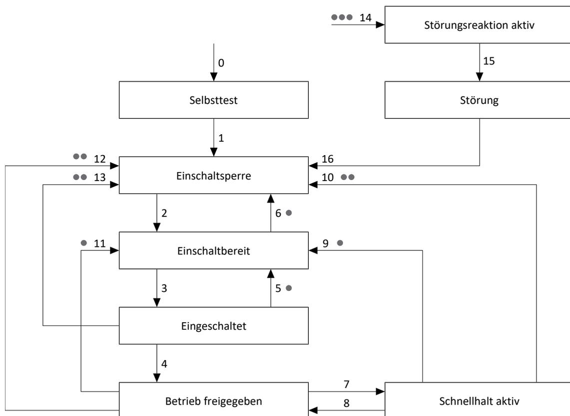
Abb. 34: Gerätezustandsmaschine Drive Based: Gerätezustände und Zustandswechsel
