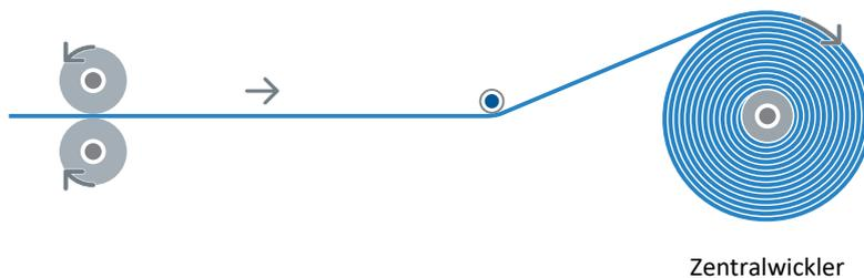
Abb. 21: Aufbau: Zentralwickler mit Geschwindigkeitssteuerung
