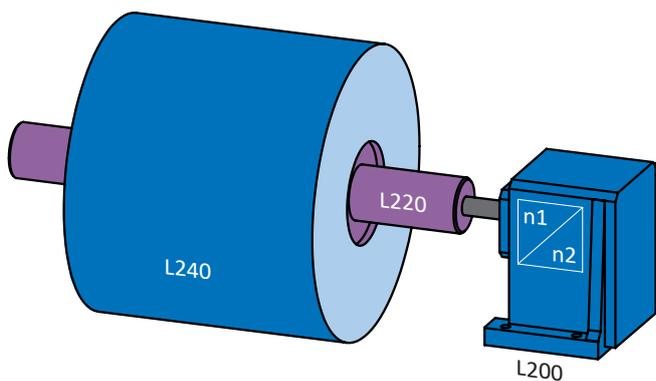
Abb. 31: Zentralwickler: Massenträgheitsmoment der Achse
