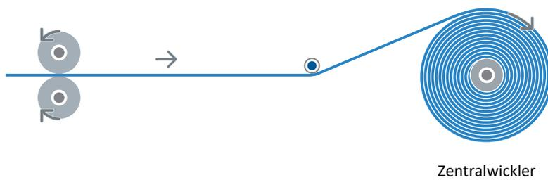
Abb. 26: Zentralwickler: Aufwickeln positiv (Wickeln von oben)
