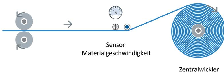
Abb. 22: Aufbau: Zentralwickler mit Geschwindigkeitsregelung
