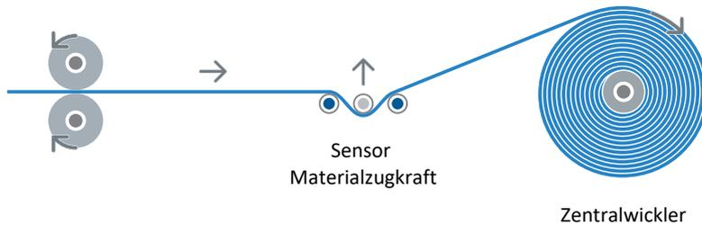
Abb. 24: Aufbau: Zentralwickler mit Zugkraftregelung
