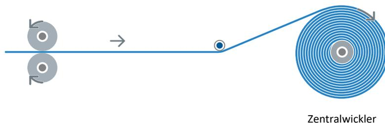
Abb. 23: Aufbau: Zentralwickler mit Zugkraftsteuerung
