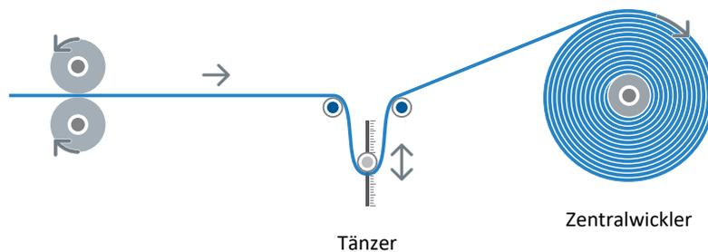
Abb. 25: Aufbau: Zentralwickler mit Tänzerpositionsregelung
