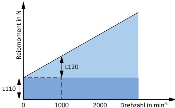
Abb. 30: Zentralwickler: Reibmoment der Achse
