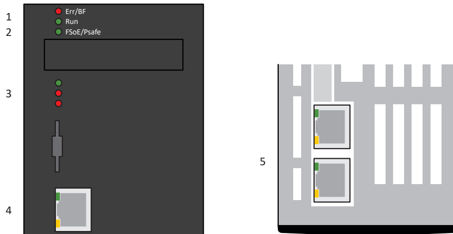
Abb. 86: Platzierung der Diagnose-Leuchtdioden auf der Gerätefront und -oberseite des Antriebsreglers
