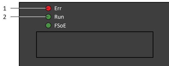
Abb. 88: Leuchtdioden für den EtherCAT-Zustand
