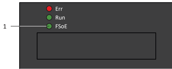
Abb. 89: Leuchtdiode für den FSoE-Zustand
