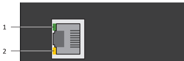
Abb. 93: Leuchtdioden für den Zustand der Service-Netzwerkverbindung
