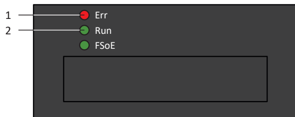
Abb. 63: Leuchtdioden für den EtherCAT-Zustand
