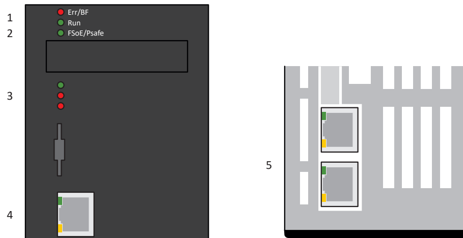
Abb. 61: Platzierung der Diagnose-Leuchtdioden auf der Gerätefront und -oberseite des Antriebsreglers
