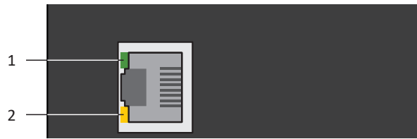
Abb. 68: Leuchtdioden für den Zustand der Service-Netzwerkverbindung
