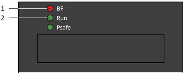
Abb. 7: Leuchtdioden für den PROFINET-Zustand
