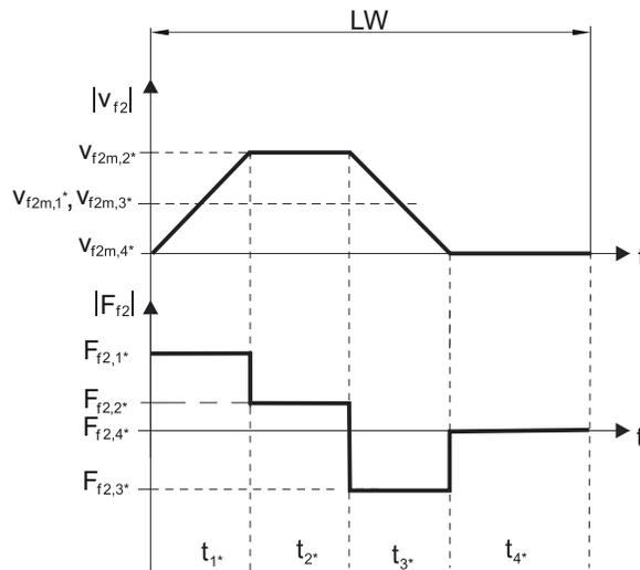
**Berechnung der vorhandenen maximalen Beschleunigungsvorschubkraft**
