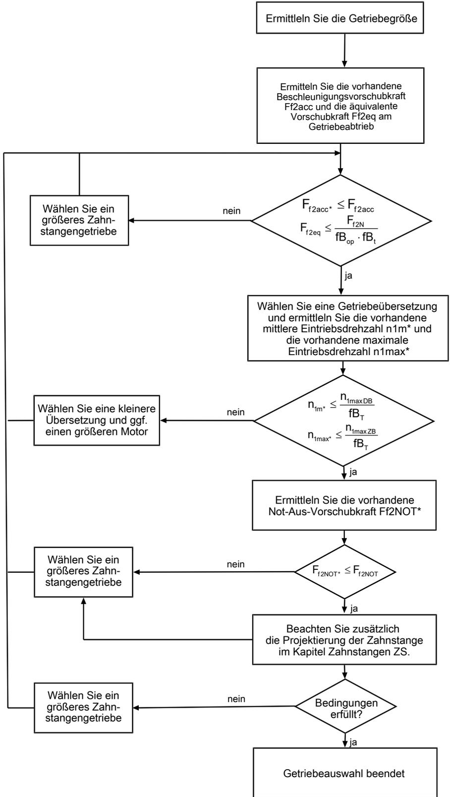
Entnehmen Sie die Werte für  $i$ ,  $n_{1maxDB}$ ,  $n_{1maxZB}$ ,  $F_{f2acc}$ ,  $F_{f2N}$  und  $F_{f2NOT}$  den Auswahltabellen. Die Kräfte sind abhängig von der Ritzelposition (E oder S). Die Drehzahlen hängen teilweise von der Einbaulage ab.
