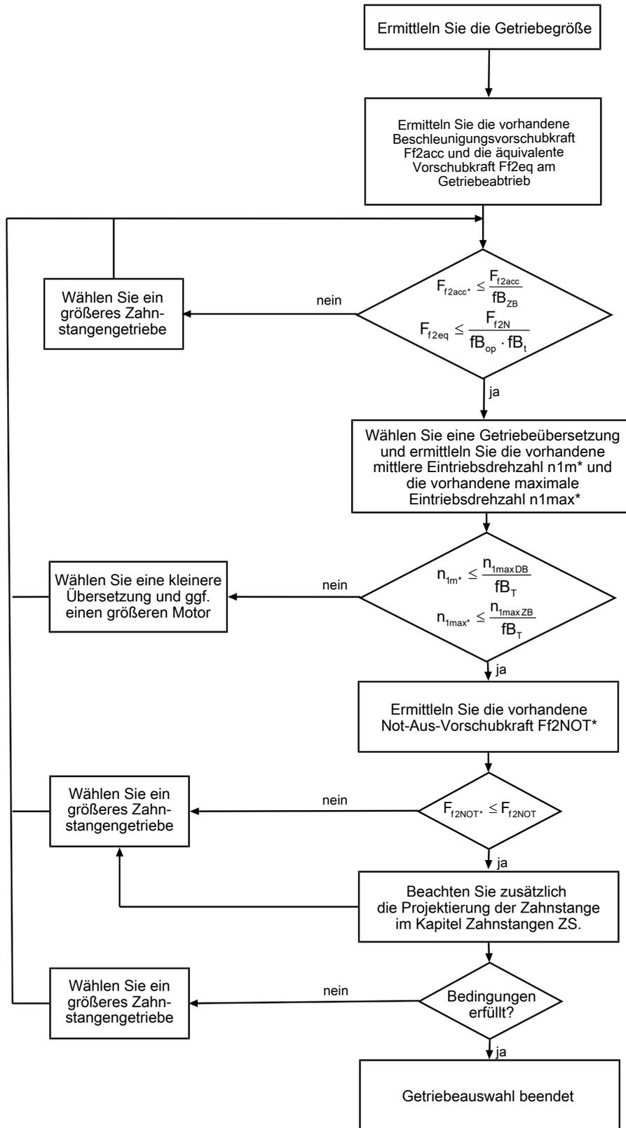
Entnehmen Sie die Werte für  $i$ ,  $n_{1maxDB}$ ,  $n_{1maxZB}$ ,  $F_{f2acc}$ ,  $F_{f2N}$  und  $F_{f2NOT}$  den Auswahltabellen. Die Kräfte sind abhängig von der Ritzelposition (E oder S). Die Drehzahlen hängen teilweise von der Einbaulage ab.
