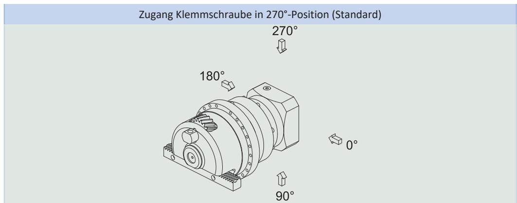
Die Zugangsbohrung zur Klemmschraube der Motorkupplung befindet sich im Standard in der 270°-Position. Geben Sie Abweichungen für Ihr Zahnstangengetriebe bei der Bestellung an.
