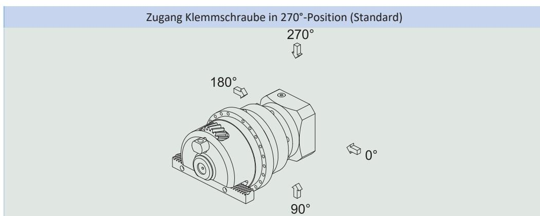
Die Zugangsbohrung zur Klemmschraube der Motorkupplung befindet sich im Standard in der 270°-Position. Geben Sie Abweichungen für Ihr Zahnstangengetriebe bei der Bestellung an.
