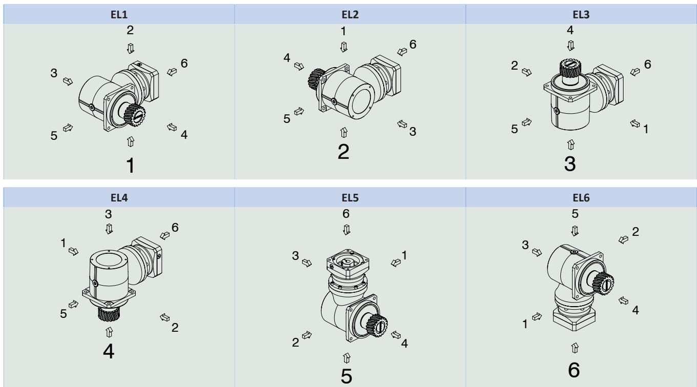
Da die Schmierstofffüllmenge der Getriebe von der Einbaulage abhängt, muss die Einbaulage für 2- und 3-stufige Getriebe bei der Bestellung angegeben werden.
