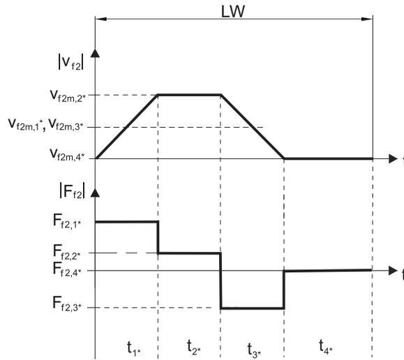
**Berechnung der vorhandenen maximalen Beschleunigungsvorschubkraft**
