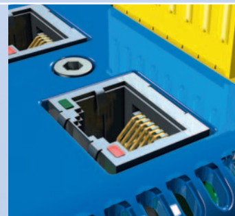
Interface pour le bus intégré IGB.
