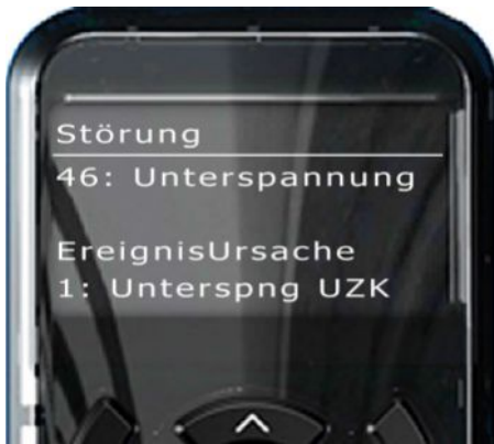
Abb. 97: Anzeige einer Störung am Display
