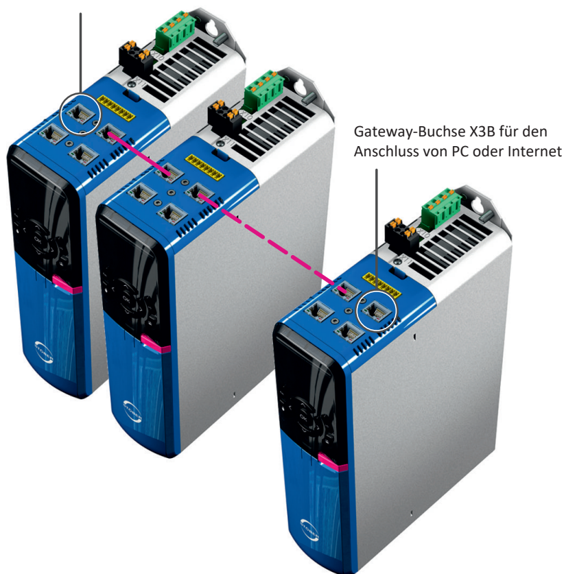
Abb. 111: IGB- und IGB-Motionbus-Netzwerk
