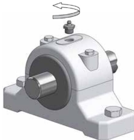
3. Reduzierstück einschrauben und eventuell erforderliche Schlauchleitungen montieren.
