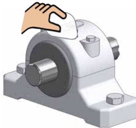
2. Entfernen Sie den Schmiernippel oder die Verschlusschraube des Anschlussgewindes und ermitteln Sie die Gewindegröße.
