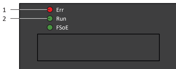
Abb. 5: Leuchtdioden für den EtherCAT-Zustand
