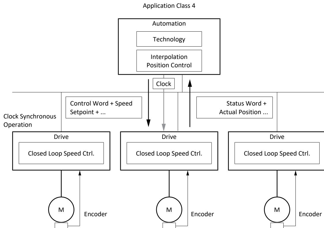
Fig. 33: PROFIdrive : classe d'application 4 (source : profil PROFIdrive)
