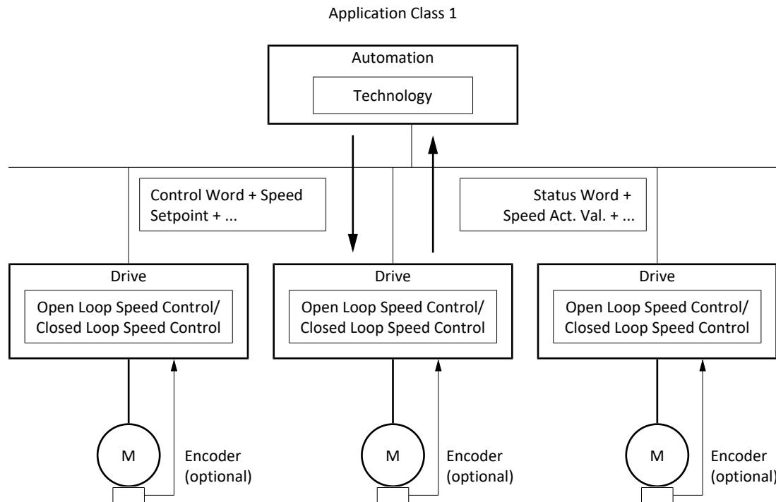
Fig. 26: PROFIdrive : classe d'application 1 (source : profil PROFIdrive)
