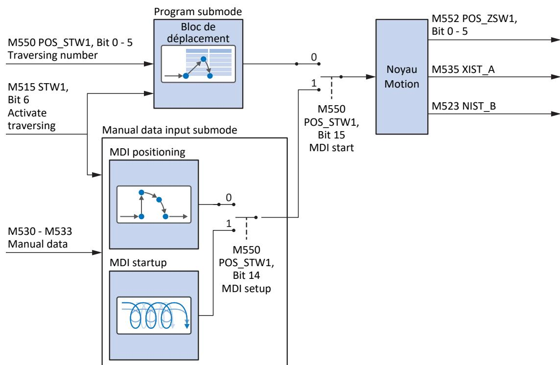
Fig. 32: Télégramme Siemens 111 dans AC3 : signaux d'entrée et de sortie
