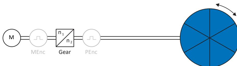
Fig. 38: Mouvement rotatoire sans fin : plateau rotatif indexé
