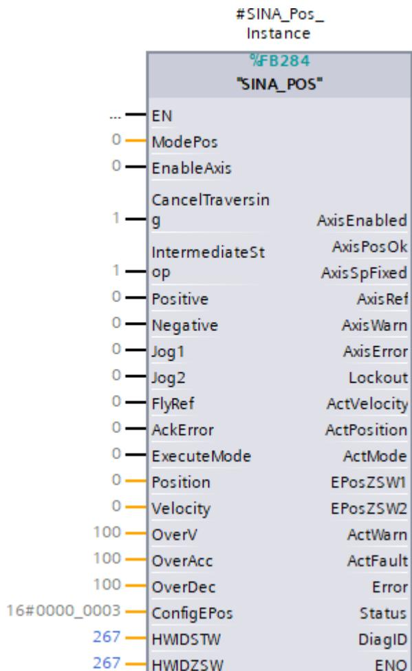
Fig. 25: Bloc fonctionnel SINA\_POS
