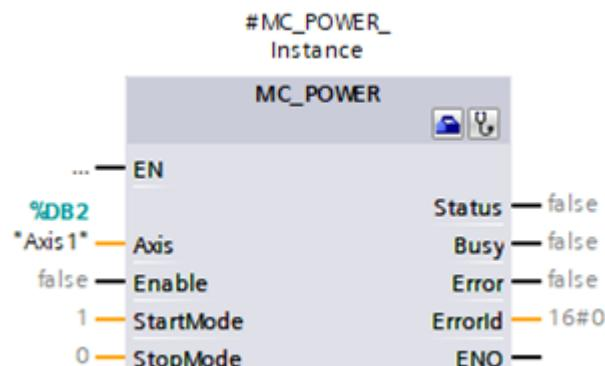
Fig. 14: Bloc PLCopen MC\_POWER
