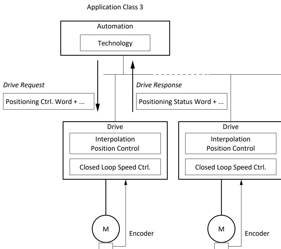
Fig. 31: PROFIdrive : classe d'application 3 (source : profil PROFIdrive)
