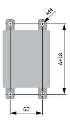
Fig. 37: KWADQU drilling diagram
