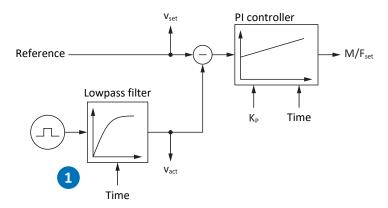
Fig. 59: Velocity controller – Filters for the actual velocity
