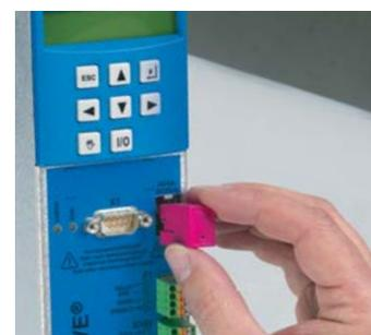
In caso di sostituzione di un POSIDRIVE® FDS 5000 è sufficiente utilizzare il vecchio Paramodul per aggiornare la programmazione del nuovo inverter, mantenendo inalterato il funzionamento precedente senza alcuna limitazione.
