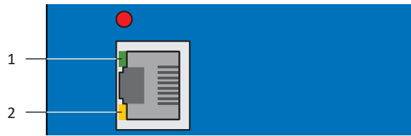
Abb. 71: Leuchtdioden für den Zustand der Service-Netzwerkverbindung
