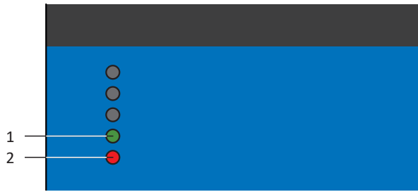
Abb. 33: Leuchtdioden für die Funktionen der S1 Bedientaste
