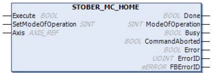
Abb. 18: Funktionsbaustein STÖBER_MC_HOME: Ein- und Ausgangsparameter
