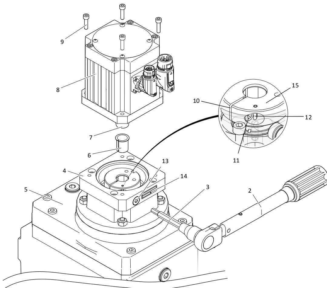
Fig. 2: Montaje de un motor en un reductor K con adaptador de motor ME (ejemplo)
