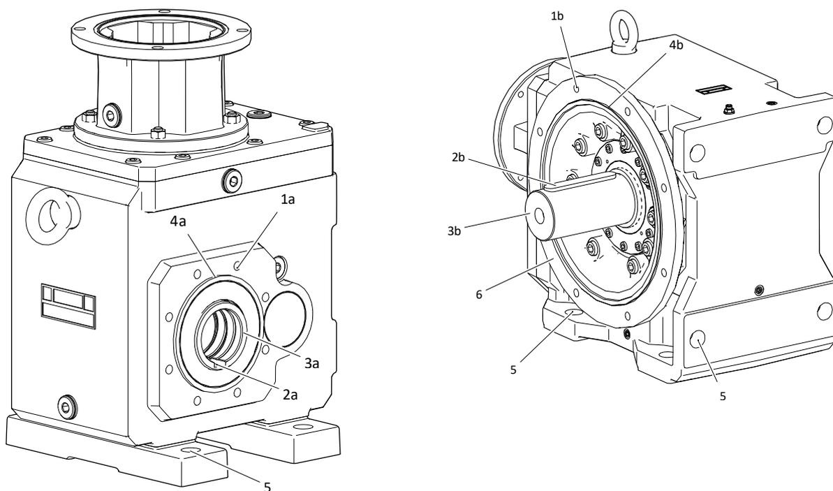
Tab. 4: Montaje del reductor en la máquina tomando como ejemplo el K513\_AF (izquierda) y un reductor K 1013\_VNF (derecha)
