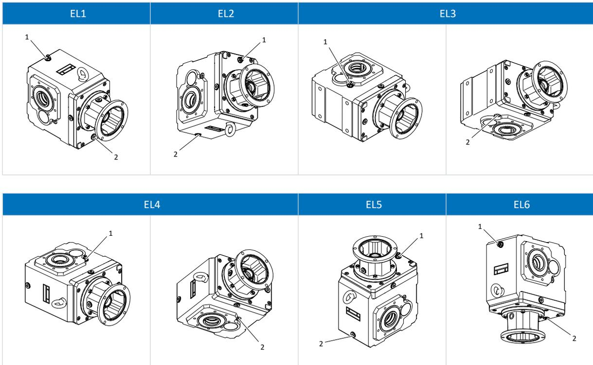
1 Válvula de purga (conexión de llenado)
