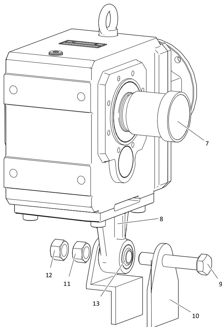
Fig. 4: Montaje de un reductor K513\_AGD (ejemplo)
