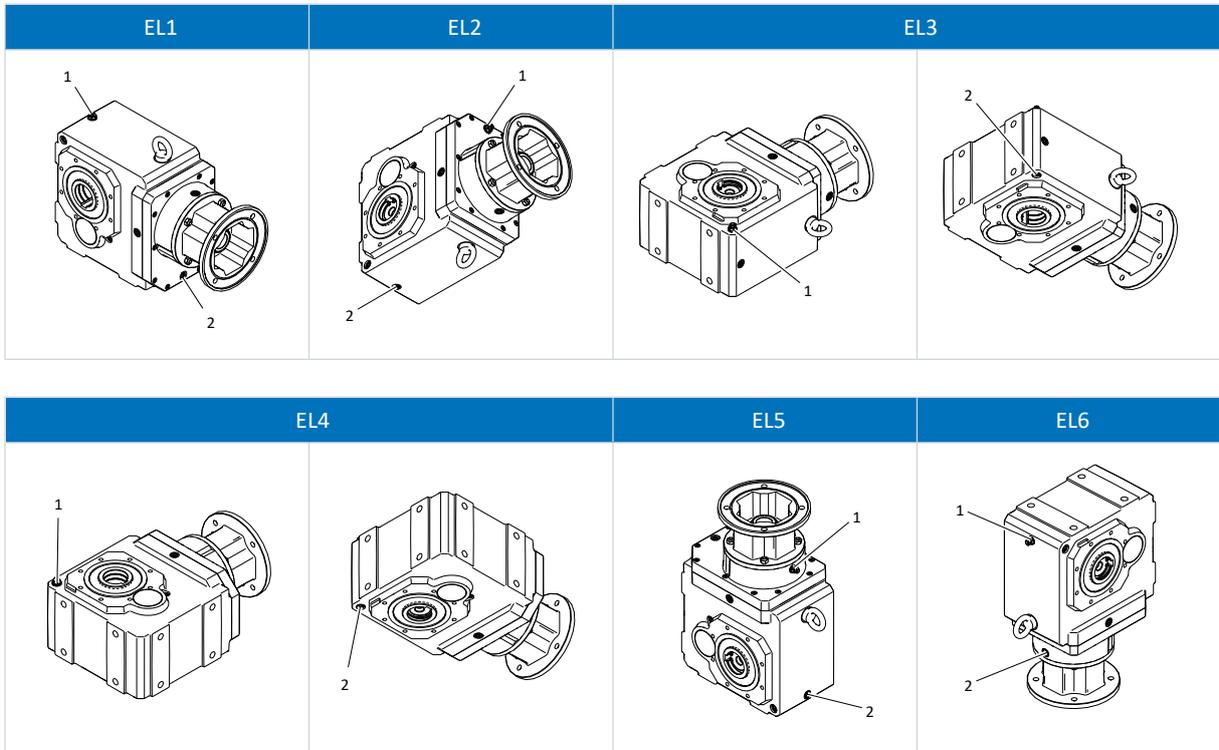
1 Válvula de purga (conexión de llenado)
