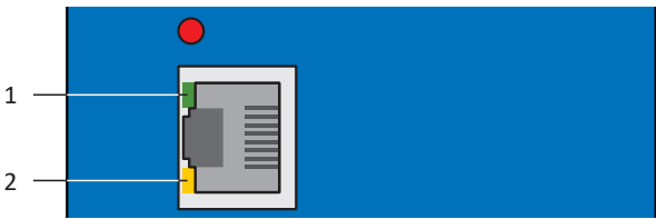
Abb. 69: Leuchtdioden für den Zustand der Service-Netzwerkverbindung
