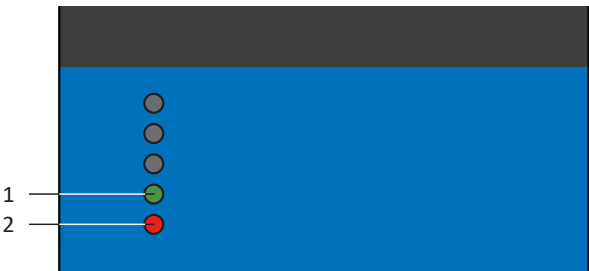
Abb. 61: Leuchtdioden für den Zustand des Antriebsreglers
