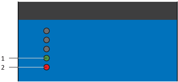
Abb. 33: Leuchtdioden für die Funktionen der S1 Bedientaste
