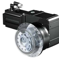
直角型行星齿轮减速电机 PHKX, PHK, PHQK 加速力矩：26 - 43000 Nm 齿隙：1 - 6 弧分 Quattro Power 所需安装空间小。
