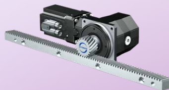
带同步伺服电机的齿轮齿条传动 ZVKS 模数：2 - 4 mm 进给力：1.3 - 11 kN 进给速度：0.08 - 3 m/s 高度灵活 用于自动化系统和机械手装置。
