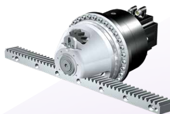
带同步伺服电机的齿轮齿条传动 ZTRSPH、ZTRSPHQ、ZTRSPHV 模数：2 - 8 mm 进给力：2.8 - 124 kN 进给速度：0.09 - 4 m/s 大进给力，确保最大功率密度。
