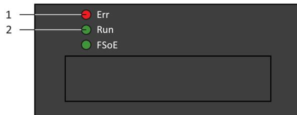
Fig. 3: DEL indiquant l'état EtherCAT
