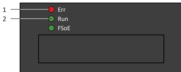
Fig. 5: DEL indiquant l'état EtherCAT
