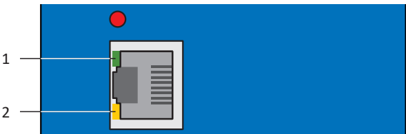
Abb. 69: Leuchtdioden für den Zustand der Service-Netzwerkverbindung
