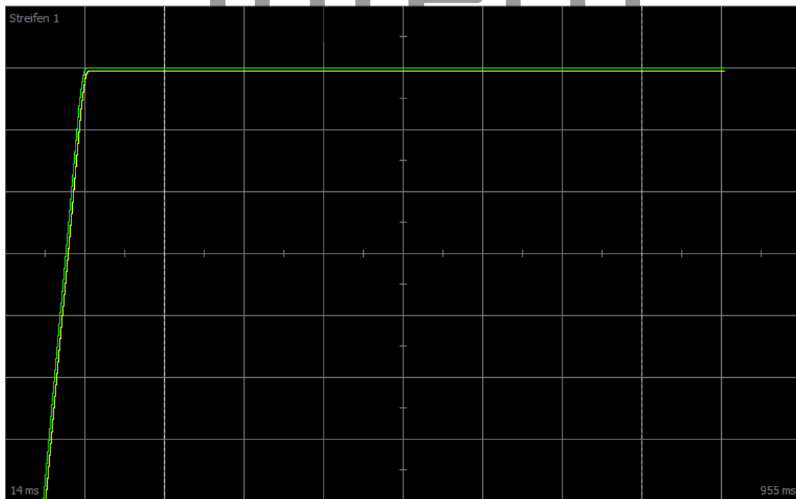
Abb. 44: Scope – Proportionalbeiwert des Geschwindigkeitsreglers (C31), optimierter Wert
