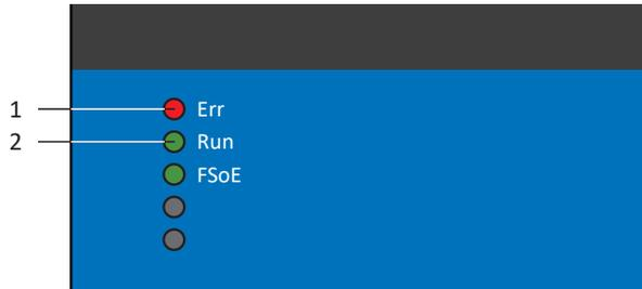
Abb. 5: Leuchtdioden für den EtherCAT-Zustand
