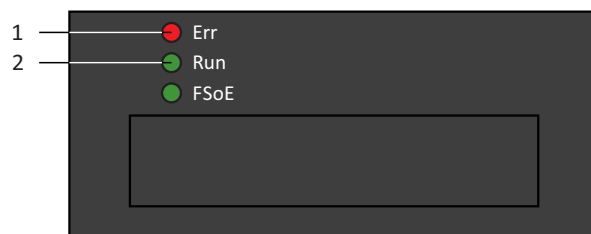
Fig. 3: DEL indiquant l'état EtherCAT
