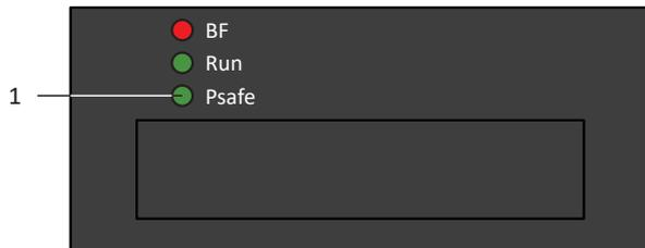
Abb. 7: Leuchtdiode für den PROFIsafe-Zustand
