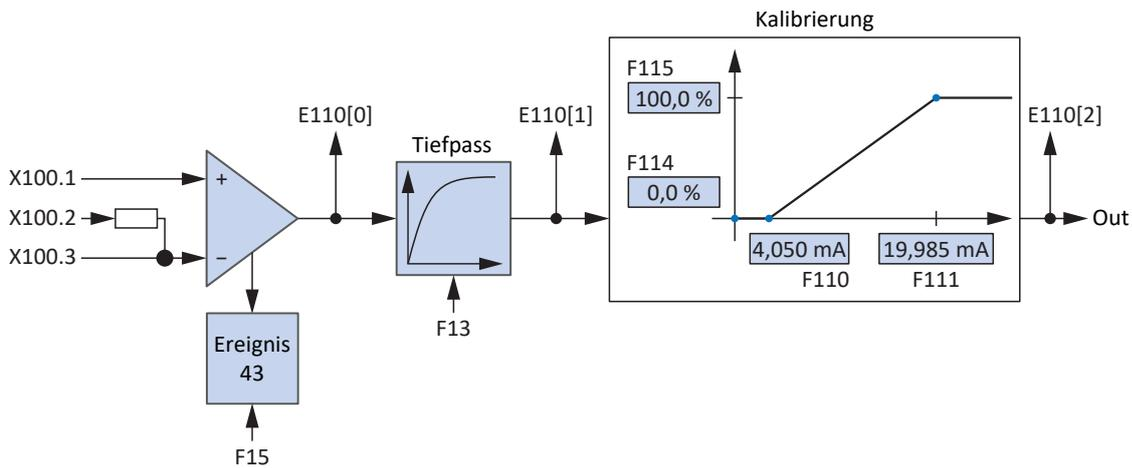
Abb. 20: Signalfussplan: analoger Eingang AI1 (F116 = 2: 4 bis 20mA)
