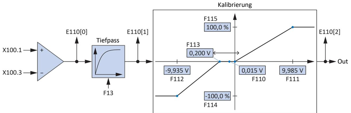
Abb. 18: Signalfussplan: analoger Eingang AI1 (F116 = 0: -10V bis 10V)
