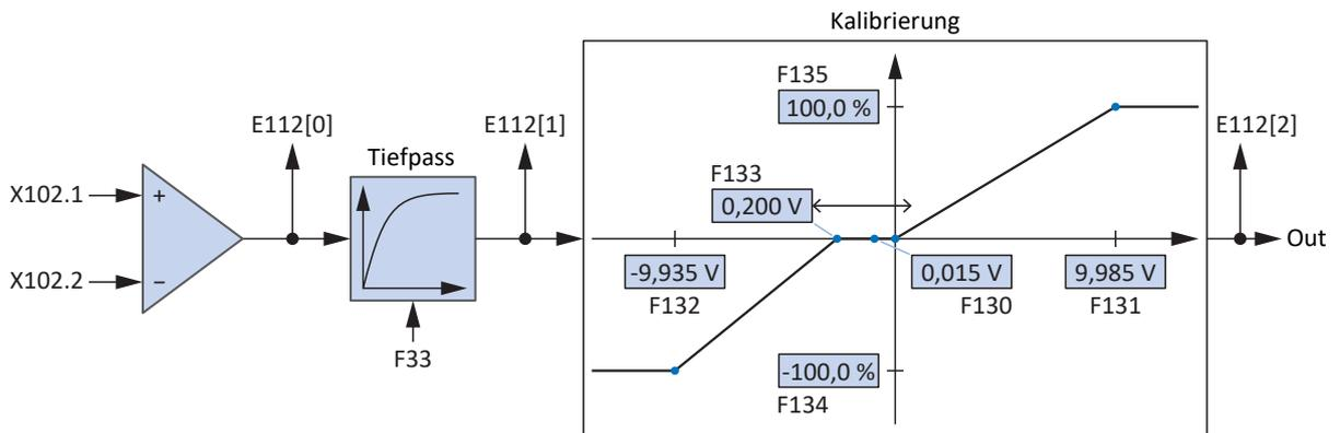
Abb. 22: Signalfussplan: analoger Eingang AI3
