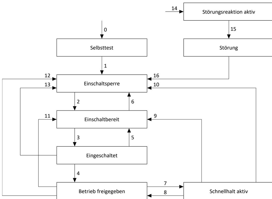
Abb. 36: Gerätezustandsmaschine Drive Based: Gerätezustände und Zustandswechsel
