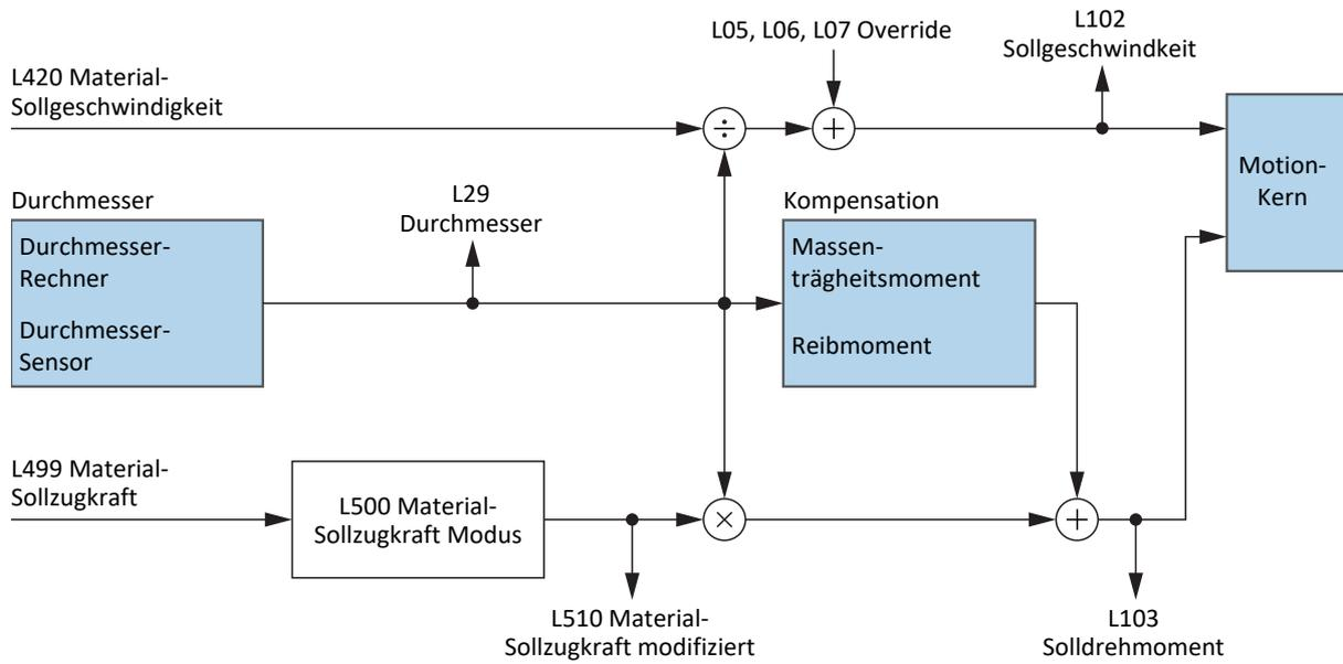
Abb. 27: Blockschaltbild: Zentralwickler mit Zugkraftsteuerung
