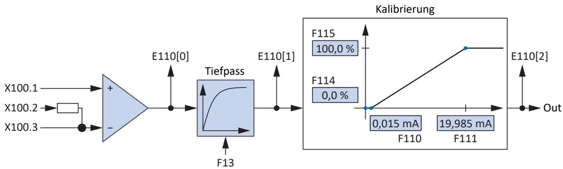
Abb. 19: Signalfussplan: analoger Eingang AI1 (F116 = 1: 0 bis 20mA)
