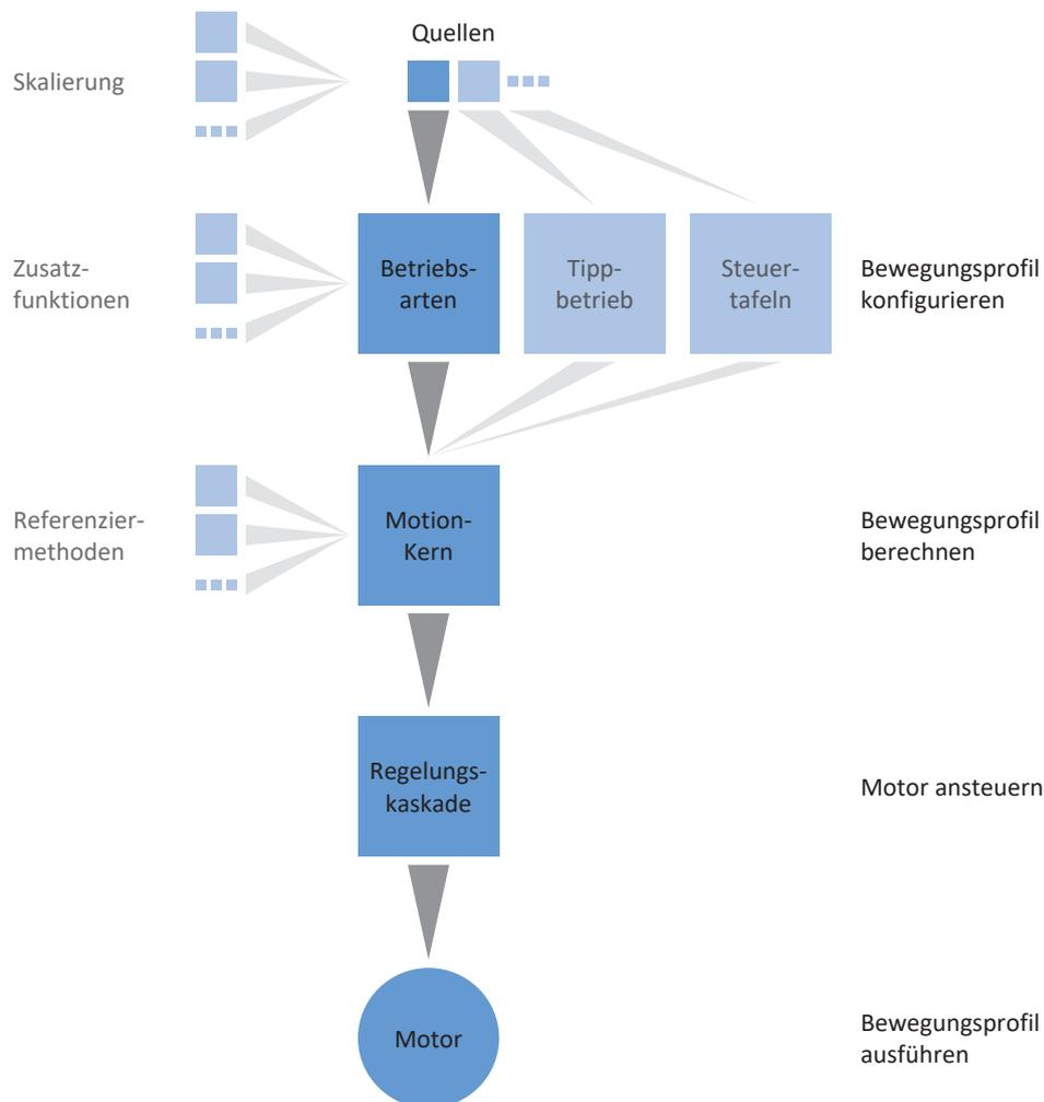
Abb. 17: Komponenten und Konfigurationsschritte
