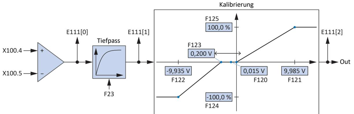
Abb. 21: Signalfussplan: analoger Eingang AI2
