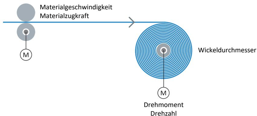
Abb. 26: Aufbau: Zentralwickler mit Zugkraftsteuerung
