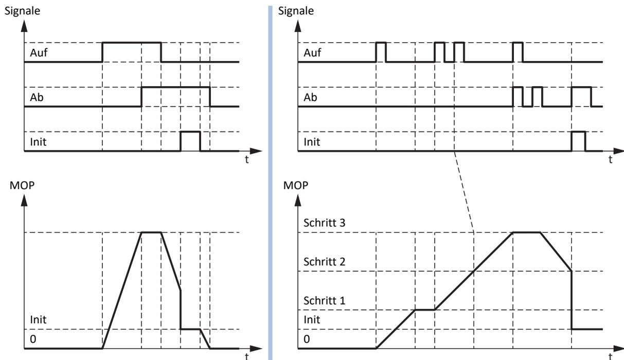
Abb. 24: Motorpotentiometer: lineare und schrittweise Berechnung
