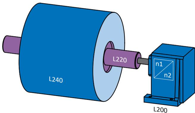
Abb. 29: Zentralwickler: Massenträgheitsmoment der Achse
