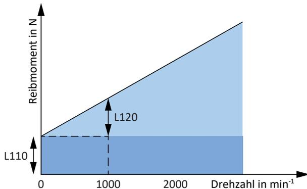
Abb. 28: Zentralwickler: Reibmoment der Achse
