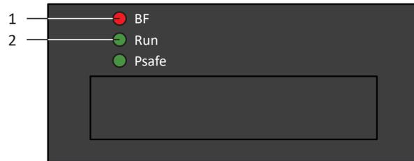
Fig. 7: Diodes électroluminescentes indiquant l'état PROFINET
