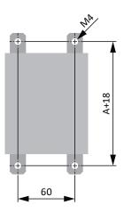
Fig. 37: KWADQU drilling diagram
