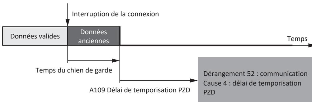
Fig. 6: PROFINET : surveillance de la connexion
