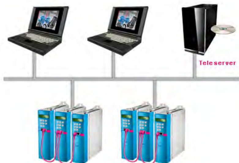
Fig. 11-19 Télémaintenance via le téléserveur
