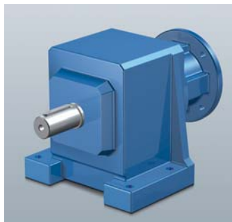
◀ Riduttori coassiali MGS C 10 grandezze: C0 – C9 Coppia di accelerazione: 70 – 8.000 Nm Rapporti di riduzione: 2 – 275 Gioco: < 10 – 20 arcmin Particolarmente flessibile grazie alle varianti di corpo
