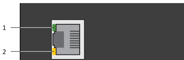
Fig. 65: Diodes électroluminescentes indiquant l'état de la connexion au réseau de maintenance
