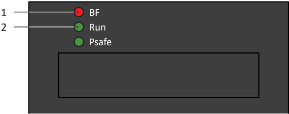
Fig. 62: Diodes électroluminescentes indiquant l'état PROFINET
