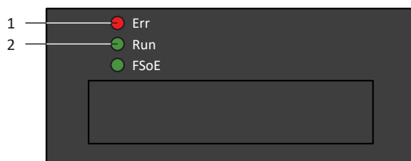
Fig. 60: DEL indiquant l'état EtherCAT
