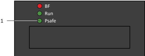
Fig. 85: DEL pour l'état PROFIsafe
