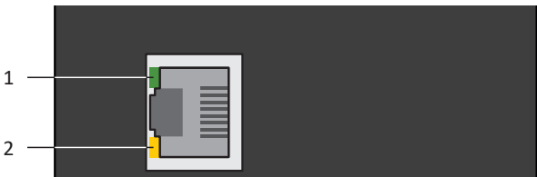
Abb. 68: Leuchtdioden für den Zustand der Service-Netzwerkverbindung
