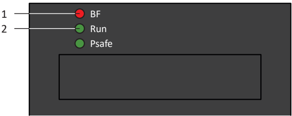
Abb. 66: Leuchtdioden für den PROFINET-Zustand
