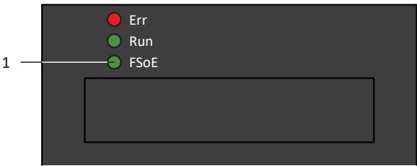
Abb. 65: Leuchtdiode für den FSoE-Zustand
