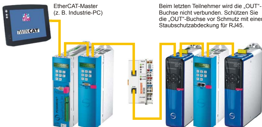
Abb. 4-1 Aufbau eines EtherCAT-Netzes
