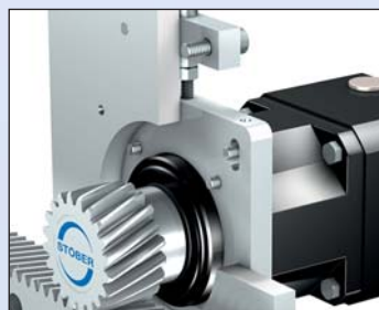
Plaque de réglage (course de réglage > hauteur de dent) pour réducteurs P et PE avec dispositif de réglage en option, pignon en position de montage E
