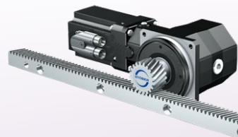
带同步伺服电机的齿轮齿条传动 ZVKS 模数：2 - 4 mm 进给力：1.3 - 11 kN 进给速度：0.08 - 3 m/s 高灵活性，用于自动装置和机械手装置。
