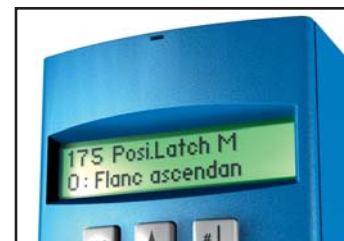
La fonction POSILatch utilise des signaux externes qu'elle évalue comme une fonction de mesure. POSILatch peut remplacer un système de mesure séparé de l'automate
