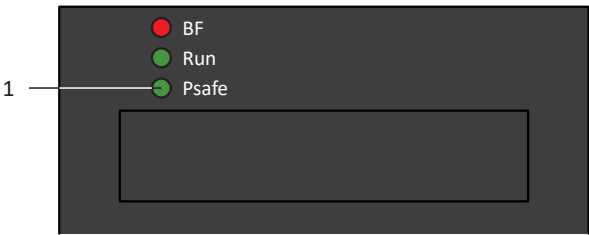
Fig. 92: DEL pour l'état PROFIsafe
