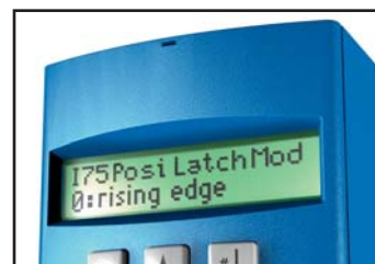
La funzione POSILatch consente di catturare la posizione attuale utilizzando segnali esterni di comando e consente anche di rilevare la distanza fra due quote
