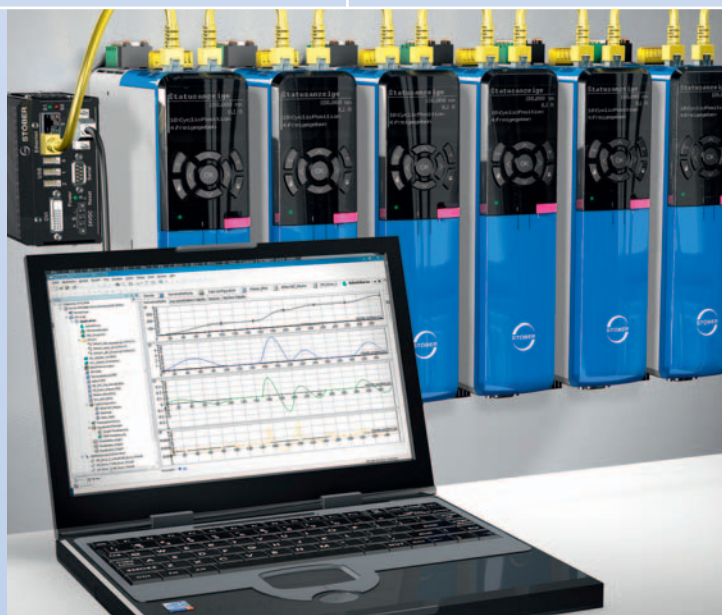
Messa in funzione centralizzata di un utilizzo multiasse CODESYS.
